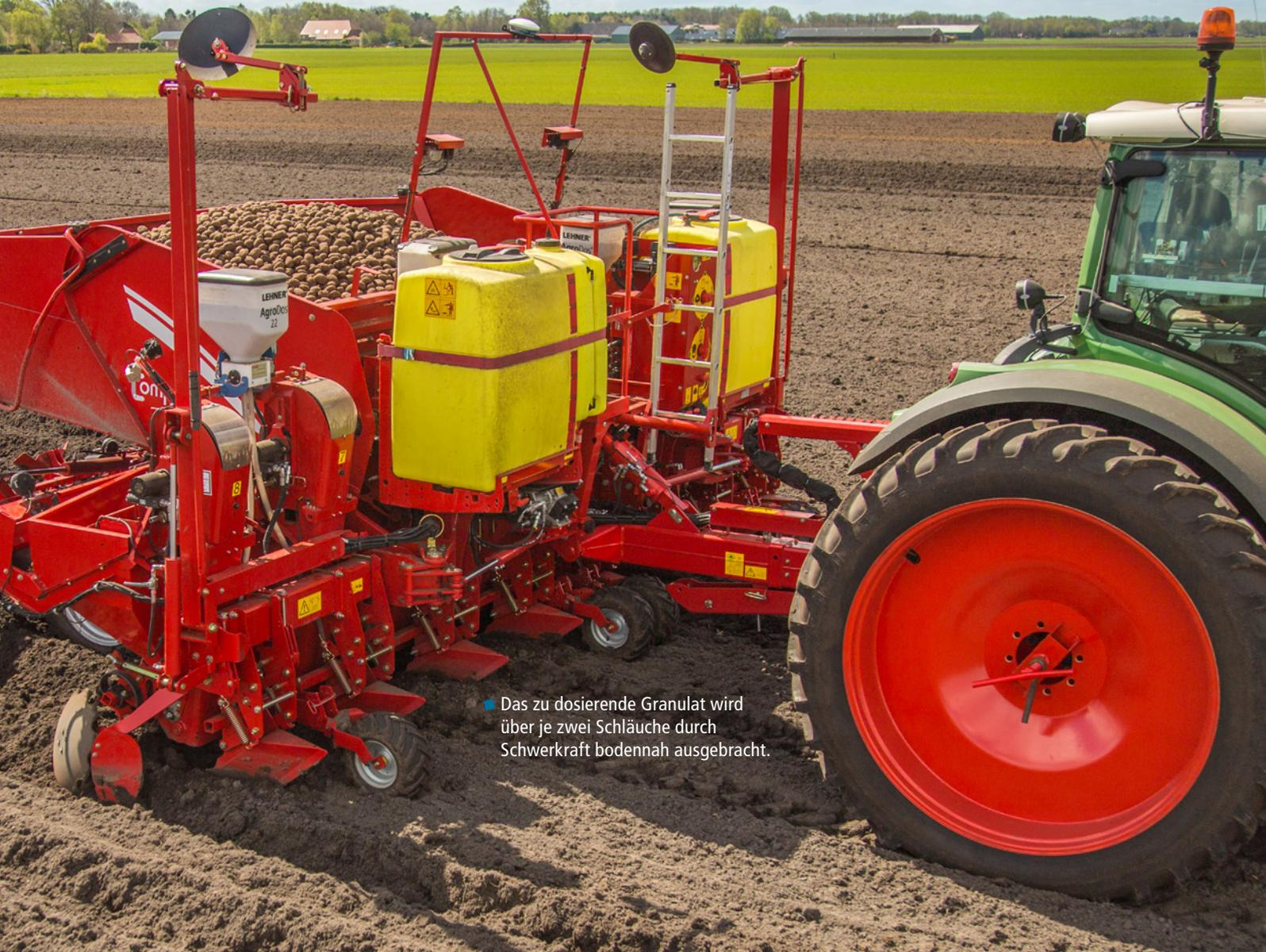
Das zu dosierende Granulat wird über je zwei Schläuche durch Schwerkraft bodennah ausgebracht.
